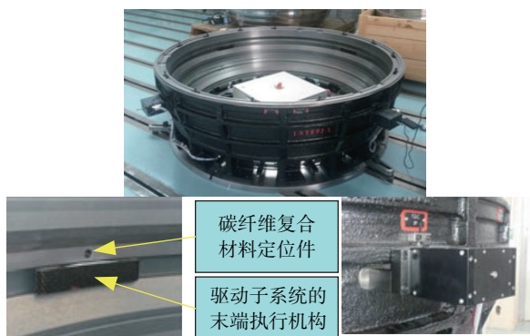
图4 低压涡轮机匣车削用主动控制夹具原型系统
